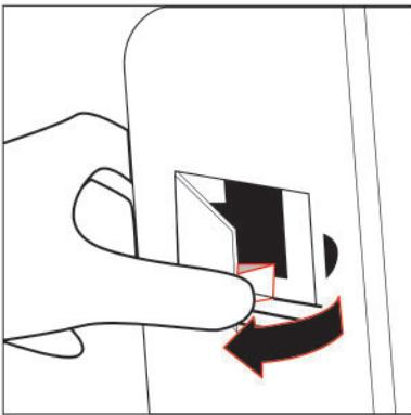
۲ « درب دریچه سنسور را با فشار دادن زبانه پلاستیک و کشیدن به سمت داخل، باز کرده و از دستگاه جدا کنید.
