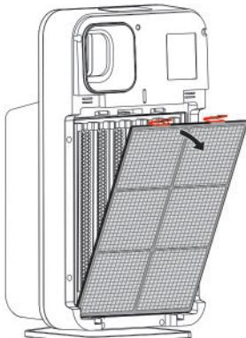
۱ « پیش فیلتر را با فشردن دو زبانه بالای فیلتر و کشیدن به کردن کامل در دستگاه قرار دهید.
