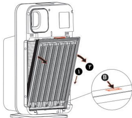
۳ « فیلتر الکترواستاتیک را با فشار دادن زبانه بالای فیلتر و کشیدن به سمت خود آزاد کنید.
